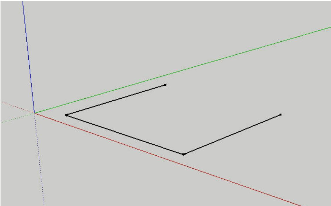
Dans l'image ci-dessus, trois droites sont tracées. Il faut en tracer une quatrième, dans le même plan, pour compléter la forme. En traçant la droite, tu remarqueras que la ligne a l'apparence d'un pointillé rouge lorsqu'elle est parallèle à l'axe rouge. Il en est de même pour les droites parallèles à l'axe vert et à l'axe bleu. Cette fonction t'aide à dessiner une forme
