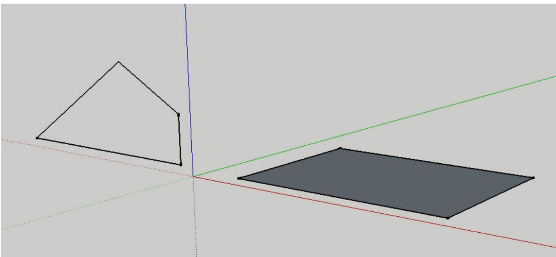
Regarde les deux formes ci-dessous. Le rectangle est gris foncé, cela indique qu'il est tracé dans un même plan. Il est possible d'étirer la forme pour créer un objet en trois dimensions. Le
